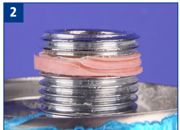
Bild 1: Das dem IFS zur Schadenursachenermittlung übersandte Kombi-Eckventil
