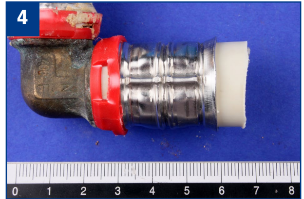
Bild 4: Die Presshülse der Verbindung sowie auch der rote Haltering des Fittings zeigen infolge eines ungeeigneten Werkzeugeinsatzes intensive plastische Verformungen und Beschädigungen.
